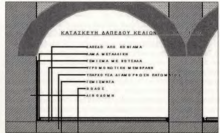
Εικ. 18 Κατασκευαστική λεπτομέρεια δαπέδου κελιών.
