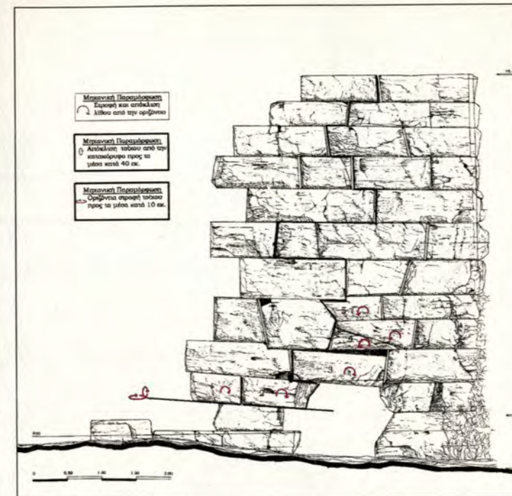
Εικ. 24: Β.Δ. όψη. Παθολογία.
