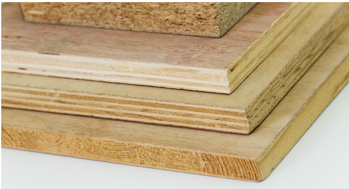
Εικόνα 5.17 Δείγματα βιομηχανικών προϊόντων ξύλων. Από πάνω προς τα κάτω, νοβοπάν, φύλλα κόντρα πλακέ, πλακάτζ.
