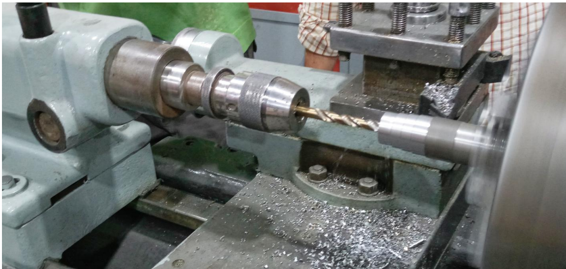
Εικόνες 6.43, 6.44, 6.45 Άποψη μηχανουργικού τόρνου, στις δύο πρώτες εικόνες το κυλινδρικό μεταλλικό στοιχείο υπόκειται σε μετωπική κοπή στην επιθυμητή διάμετρο. Στην τρίτη εικόνα το σταθερό τρυπάνι μετακινείται και ανοίγει τρύπα στο περιστρεφόμενο μέταλλο.
