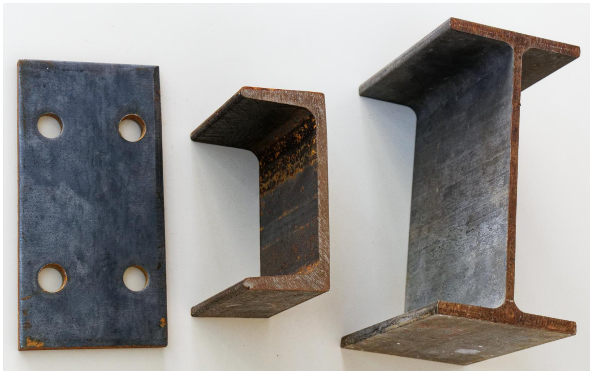
Εικόνα 6.35 Τυπικές χαλύβδινες διατομές, προϊόντα κατεργασίας μετάλλου εν θερμώ. Η λάμα είναι προϊόν έλασης και οι ανοικτές χαλύβδινες διατομές (UNP και IPE) είναι προϊόντα διέλασης.
