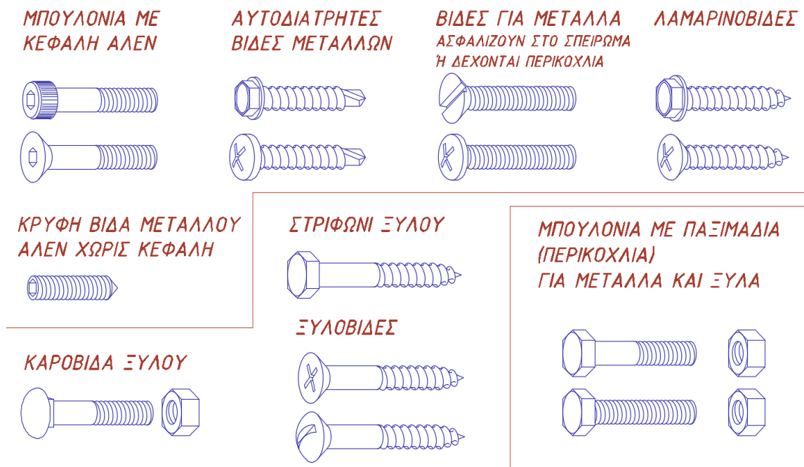
Σχέδιο 6.15 Τυπολόγιο από βίδες, στριφώνια και μπουλόνια για μέταλλα ή ξύλα με κεφαλές διαφόρων τύπων.
