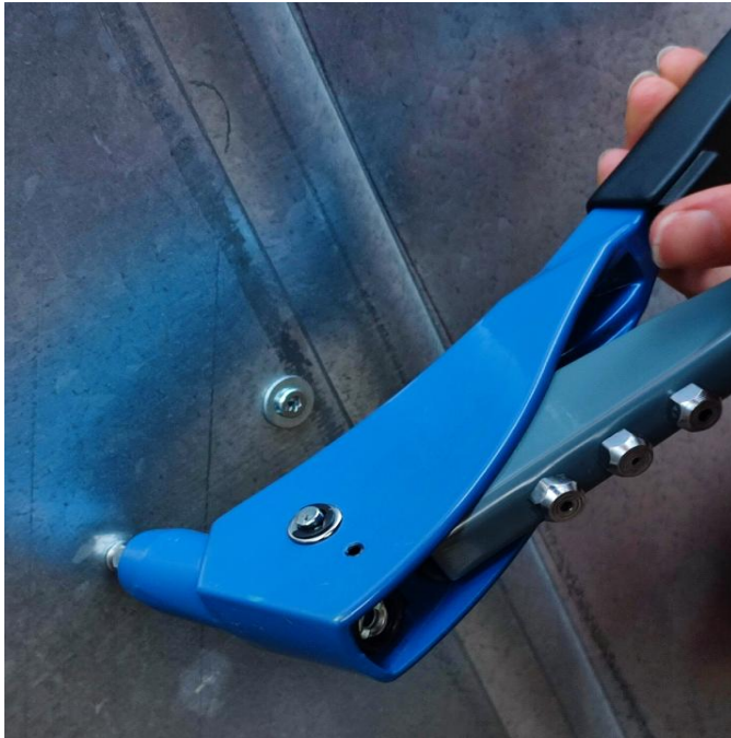
Εικόνα 6.47 Σύνδεση φύλλων λαμαρίνας με πριτσίνια.
