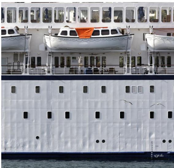
Εικόνες 1.47, 1.48 Η κλίμακα μεγέθους του πλοίου επιβάλλει τη χρήση χάλυβα. Πίσω από την επιδερμίδα της λαμαρίνας, διαγράφεται αδρά το δομικό σύστημα από επάλληλα διατεταγμένους χαλύβδινους νομείς. Αντίθετα, οι μικρές σωστικές λέμβοι είναι πολυεστερικές.
