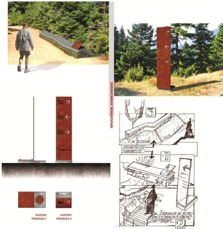
Εικόνα 10.17 Στοιχεία σήμανσης με τη μορφή totem ή εναλλακτικά με τη μορφή μεταλλικής πλακέτας τοποθετημένης σε κτιστό καθιστικό. Η εγγραφή γραμμωτού κώδικα QR, για είσοδο στον ψηφιακό χώρο περιήγησης και ξενάγησης, μπορεί να χαράσσεται στις μεταλλικές επιφάνειες των στοιχείων σήμανσης.
