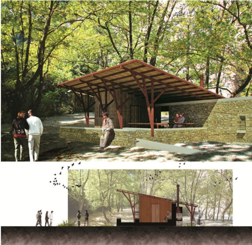
Εικόνα 10.16 Κατασκευή αναψυκτηρίου, με συσχετισμό ελαφρών αναστρέψιμων τμημάτων του μικρού κτιριακού κελύφους και λιθόκτιστων μερών.
