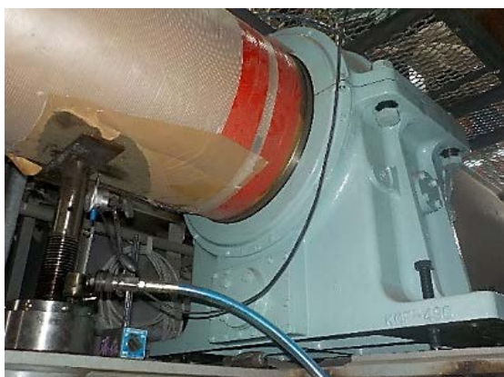
Εικ. 3.101 Μέτρηση φορτίου ενδιάμεσου εδράνου.
