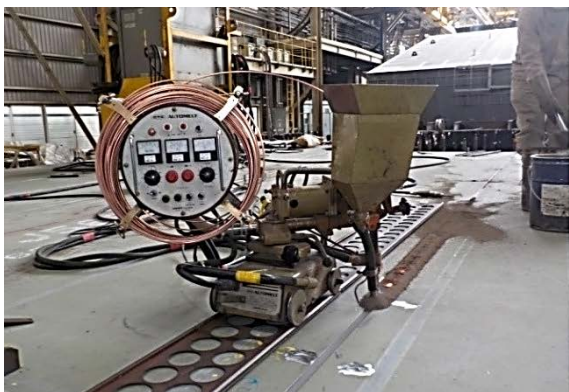
Εικ. 3.33 , Εικ.3.34 Συγκολλήσεις με φορητές αυτόματες μηχανές.
