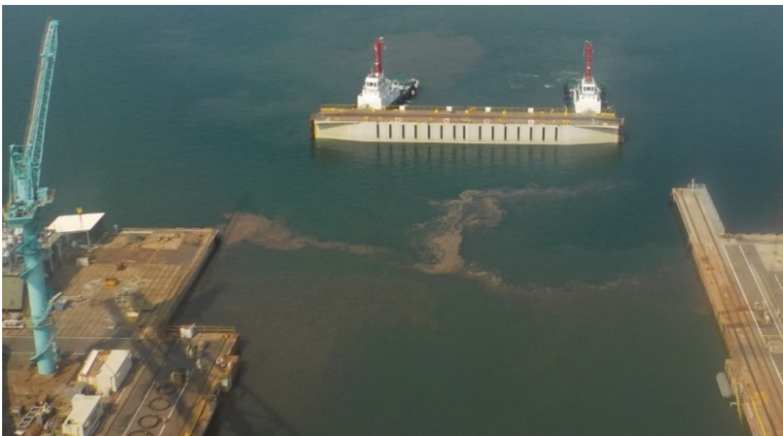
Εικ. 3.11 Μετακίνηση πλωτής θύρας με τη βοήθεια ρυμουλκών.
