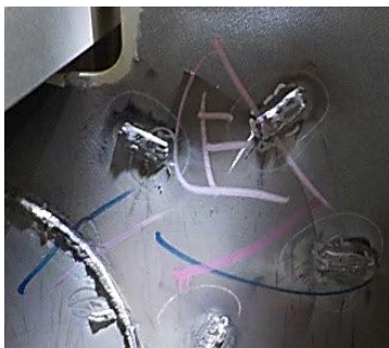
Εικ.3.35-Εικ. 3.38 Ατέλειες συγκολλήσεων.
