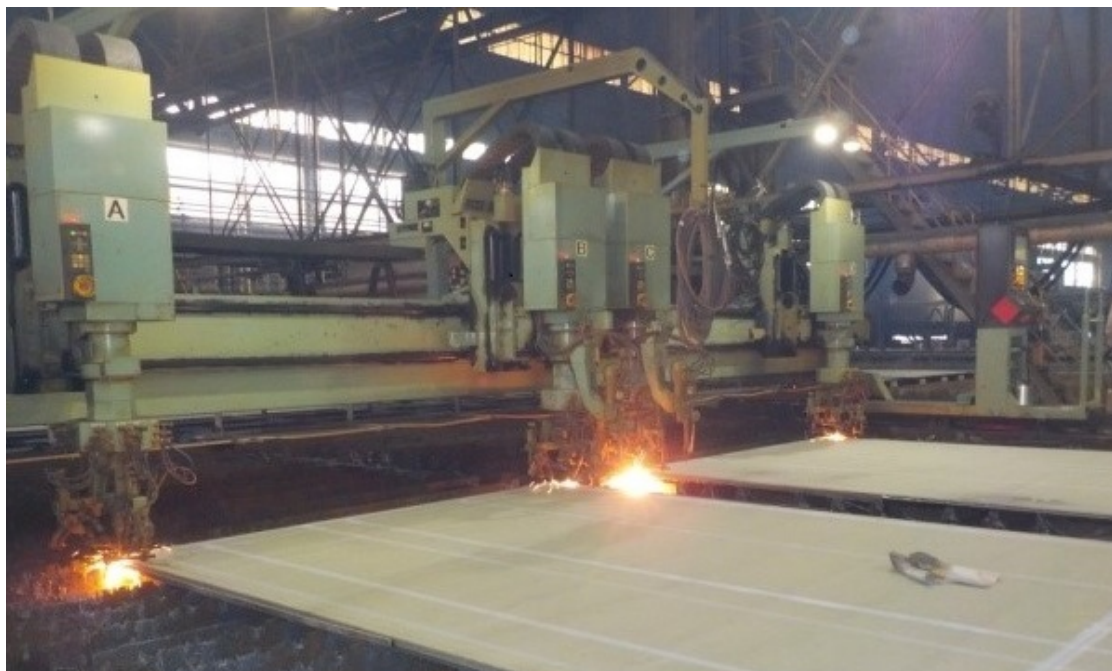
Εικ. 3.23, Εικ. 3.24 Αυτόματες μηχανές κοπής με πλάσμα.
