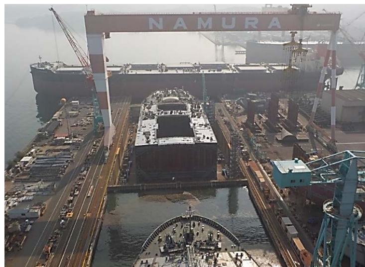
Εικ. 3.15 Καθέλκυση σε μόνιμη δεξαμενή δύο εισόδων.
