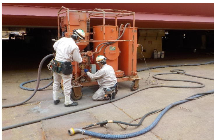
Εικ. 3.84 Συσκευή αμμοβολής υπό κενό.
