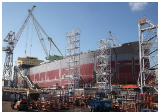
Εικ. 3.1 Ναυπήγηση σε επικλινές επίπεδο. Χρήση γερανών περιστρεφόμενου προβόλου.
