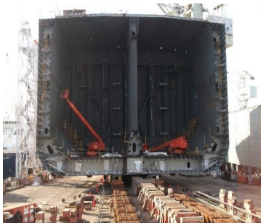
Εικ. 3.3 , Εικ. 3.4 Μετατόπιση ημιτελούς πρύμνης επί γραμμικών ένσφαιρων τριβέων.
