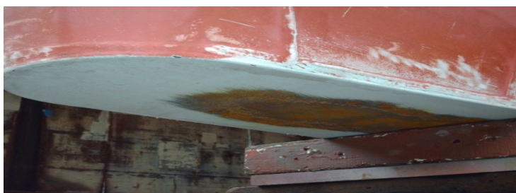
Εικ. 3.7 Ζημιά στην πρύμνη ύστερα από ήπια προσάραξη σε αμμώδη πυθμένα κατά την καθέλκυση.
