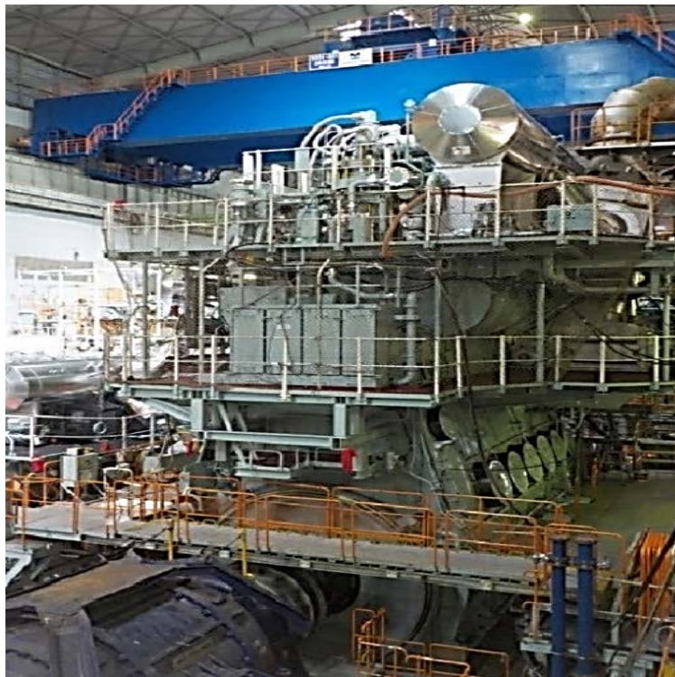
Εικ. 3.59 Δοκιμή κύριας μηχανής στο εργοστάσιο του κατασκευαστή.
