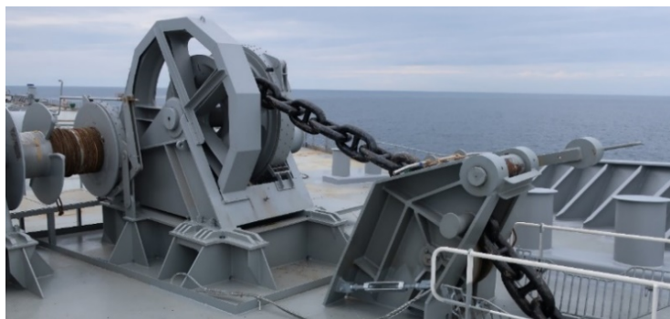
Εικ. 3.109 Δοκιμή βαρούλκων άγκυρας.
