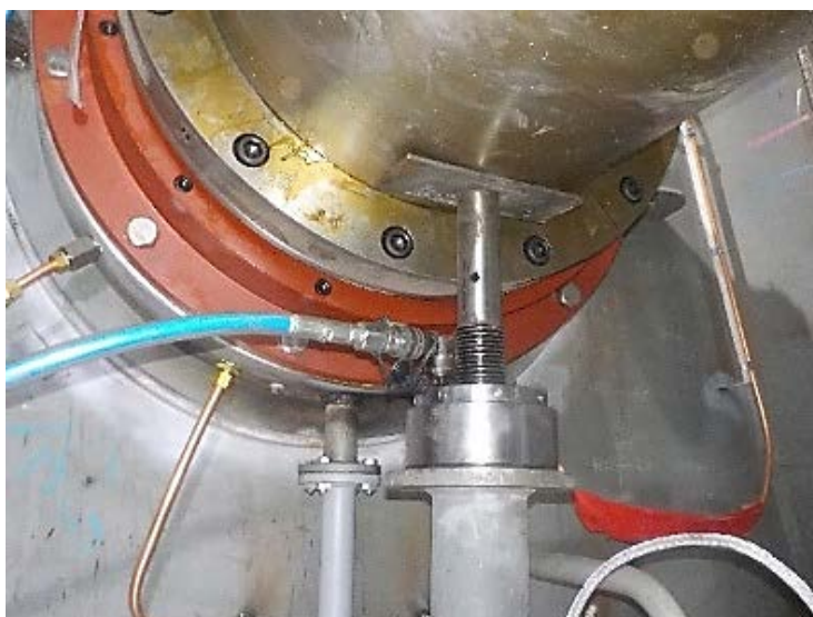
Εικ. 3.100 Μέτρηση φορτίου πρυμναίου εδράνου.
