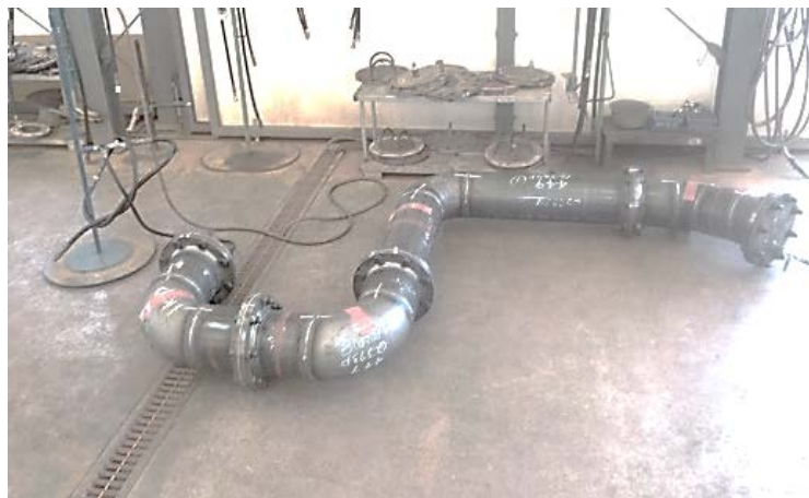
Εικ. 3.50 Δοκιμή αντοχής σωληνώσεων σε υδροστατική πίεση.
