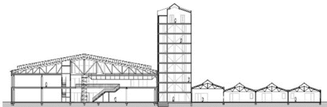
Εικ. 0.165 Smederij. Τομή κατά μήκος του συγκροτήματος μετά τις εργασίες ανακατασκευής.
