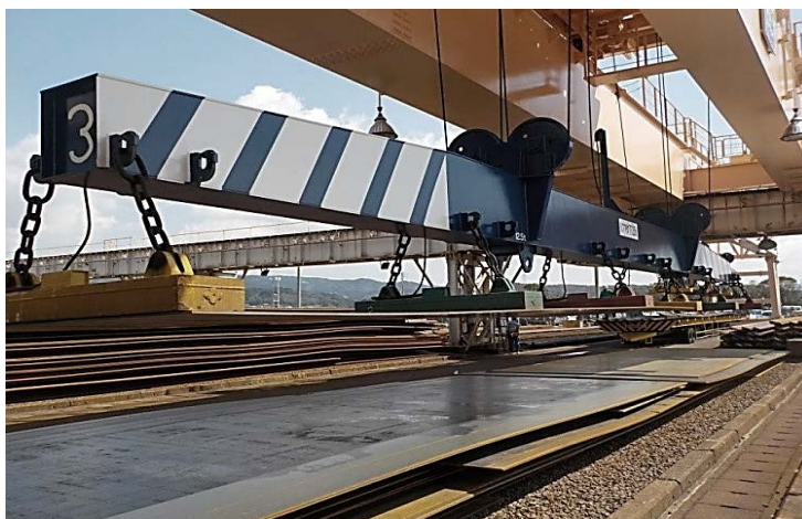
Εικ. 3.21 Παραλαβή και μεταφορά ελασμάτων με μαγνητικές αρπάγες.
