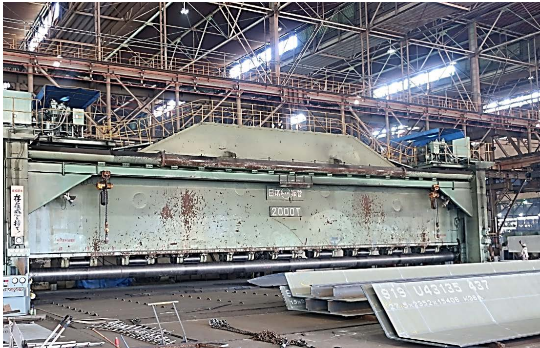
Εικ. 3.25 Μηχανή κάμψης με οριζόντια έλαστρα.
