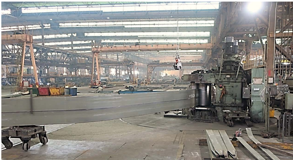
Εικ. 3.26 Μηχανή κάμψης με κατακόρυφα έλαστρα.
