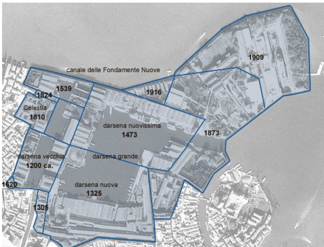
Εικ. 2.26 Διάγραμμα των διαδοχικών επεκτάσεων στο Arsenale της Βενετίας στη διάρκεια επτά αιώνων.
