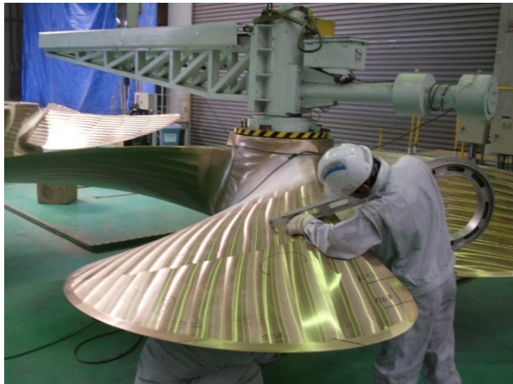
Εικ. 3.70 Μέτρηση πάχους πτερυγίων σε προδιαγεγραμμένα σημεία.
