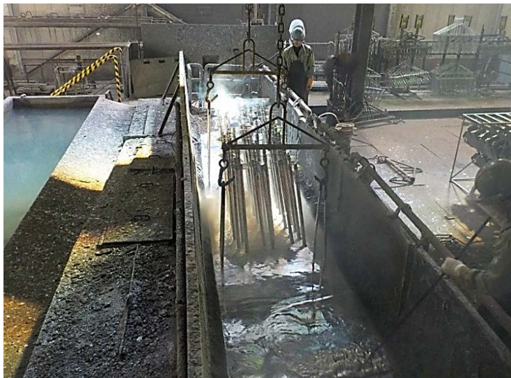
Εικ. 3.53 Γαλβανισμός σε τήγμα ψευδαργύρου.
