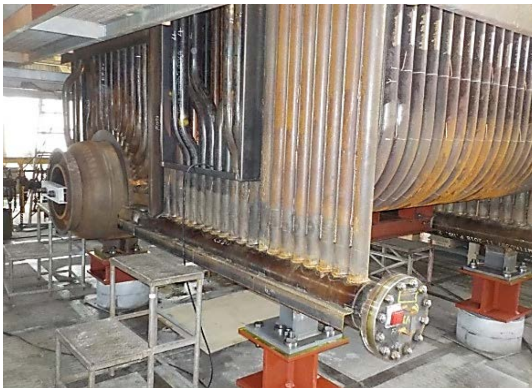
Εικ. 3.66 , Εικ. 3.67 Δοκιμή πίεσης λεβήτων.
