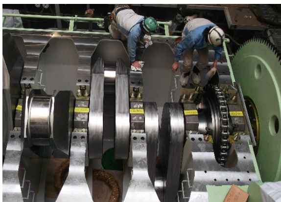
Εικ. 3.93 - Εικ. 3.94 Τοποθέτηση και συναρμολόγηση της κύριας μηχανής σε δύο κομμάτια.
