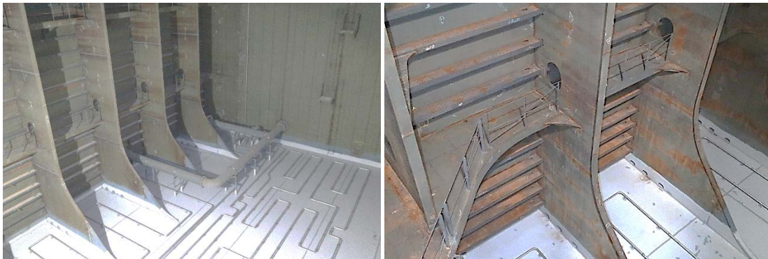
Εικ. 3.115 Άβαφη δεξαμενή φορτίου πριν τις θαλάσσιες δοκιμές.
