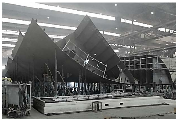
Εικ. 0.1 Προκατασκευή τομέων πλοίου στο ναυπηγείο Namura, Imari, Ιαπωνία.
