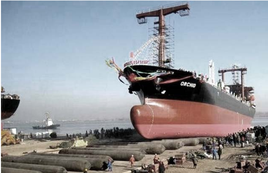
Εικ. 3.5 Καθέλκυση με χρήση ελαστικών πλωτήρων.
