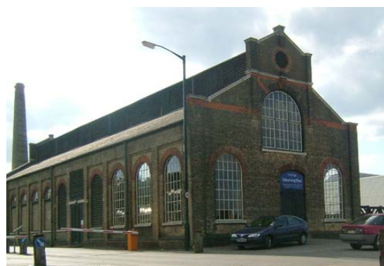
Εικ. 2.42 Chatham HD Galvanising (1890). Ο γαλβανισμός είναι μία διαδικασία όπου ο σίδηρος προστατεύεται από τη σκουριά με εμβάπτιση σε λιωμένο ψευδάργυρο. Για τον καθαρισμό του μετάλλου χρησιμοποιούνται λουτρά οξέος. Οι αναθυμιάσεις έβγαιναν μέσα από τις περιίδες στην οροφή του τούβλινου κτιρίου.
