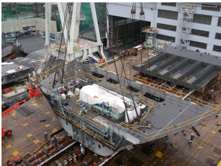
Εικ. 3.72 Έναρξη ανέγερσης σε επικλινή ναυπηγική κλίση.
