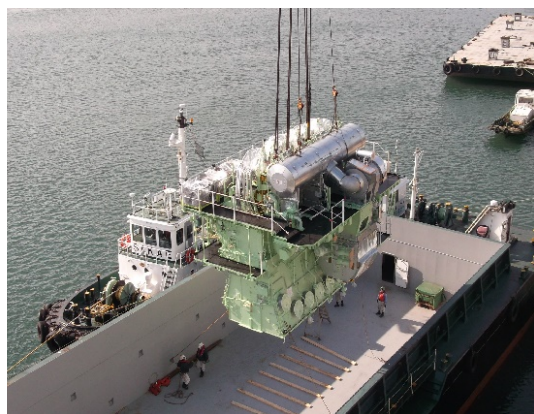
Εικ. 3.93 - Εικ. 3.94 Τοποθέτηση και συναρμολόγηση της κύριας μηχανής σε δύο κομμάτια.
