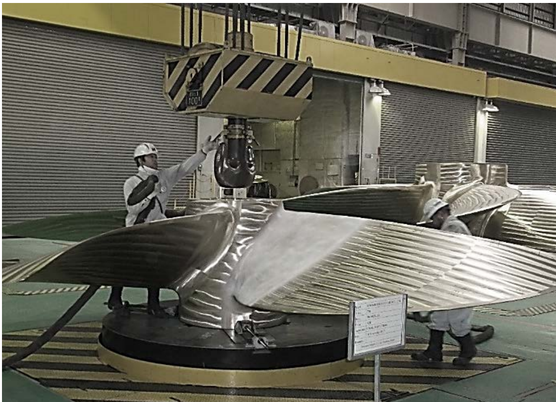
Εικ. 3.69 Τοποθέτηση της έλικας σε ζυγό στατικής ζυγοστάθμισης.
