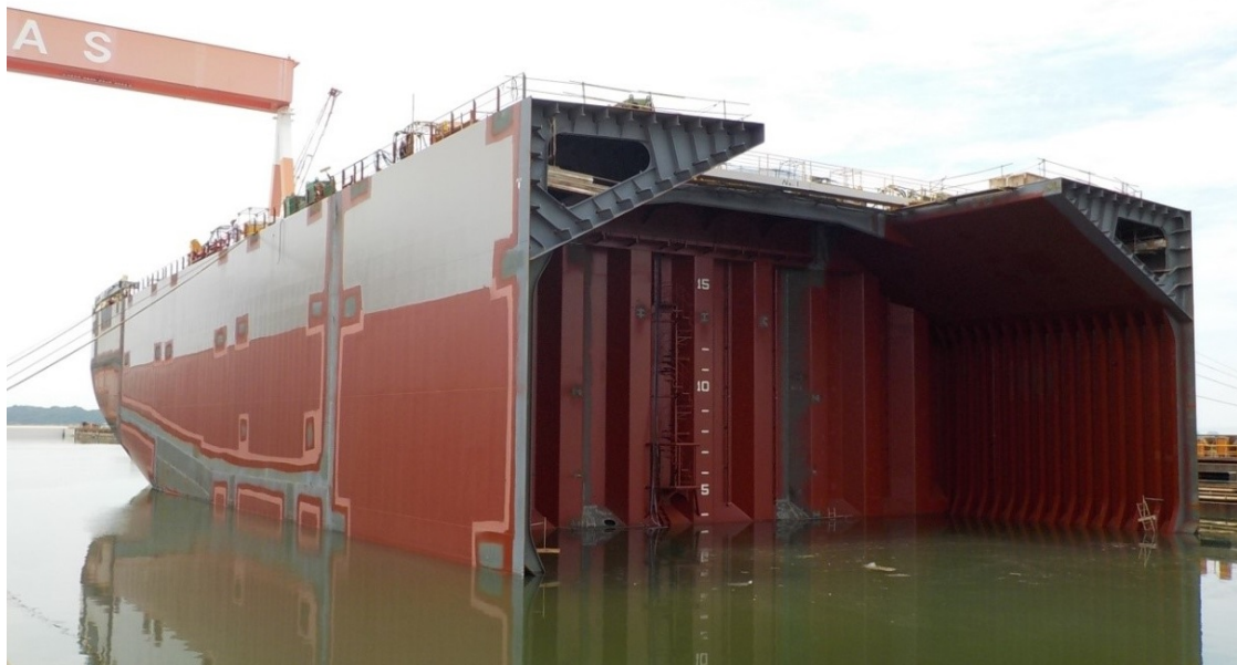
Εικ. 3.12 Μεταφορά εν υγρώ ημιτελούς πρύμνης.
