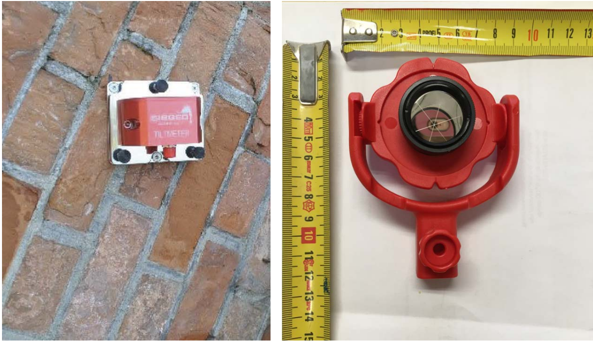
Εικόνα 9-46. Κλισίμετρο δύο διευθύνσεων και 3D πρισματικός στόχος. Φωτό: Ερευνητική Ομάδα, 2023.
